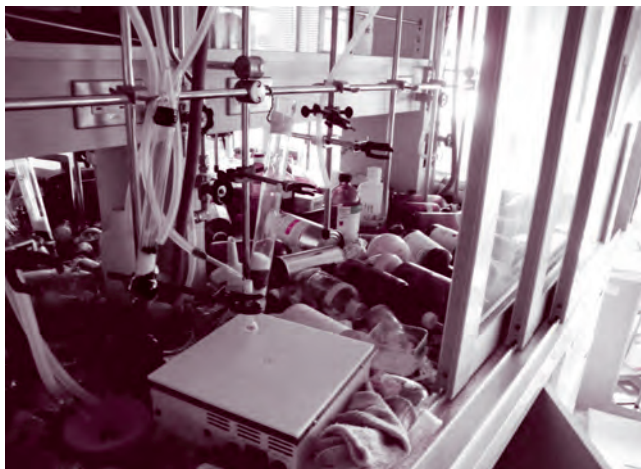
図5 お見せしたくないが、状況の悪い実験台の一つ 手元に置いていた試薬瓶が実験台上に散乱しているが、ベンチ フードに遮られ床に落ちた本数は少なかった。手前は、大事な反 応が進行しているはずの反応管。この結果はどうだったのか……。
